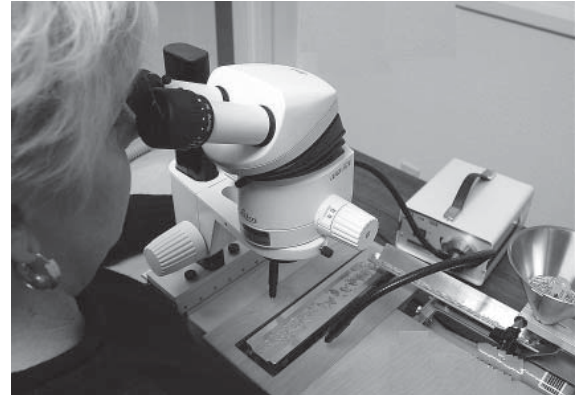
جهاز EVs قيد الإستعمال، حيث يجلس المحلل بوضعية مريحة وصحية ومستخدما كلتا عينييه بدرجة تكبير مثلى، تتدفق البذور بشكل مستمر، ويمكن إيقاف العملية وإعادة تشغيلها لإزالة الشوائب في أية لحظة
